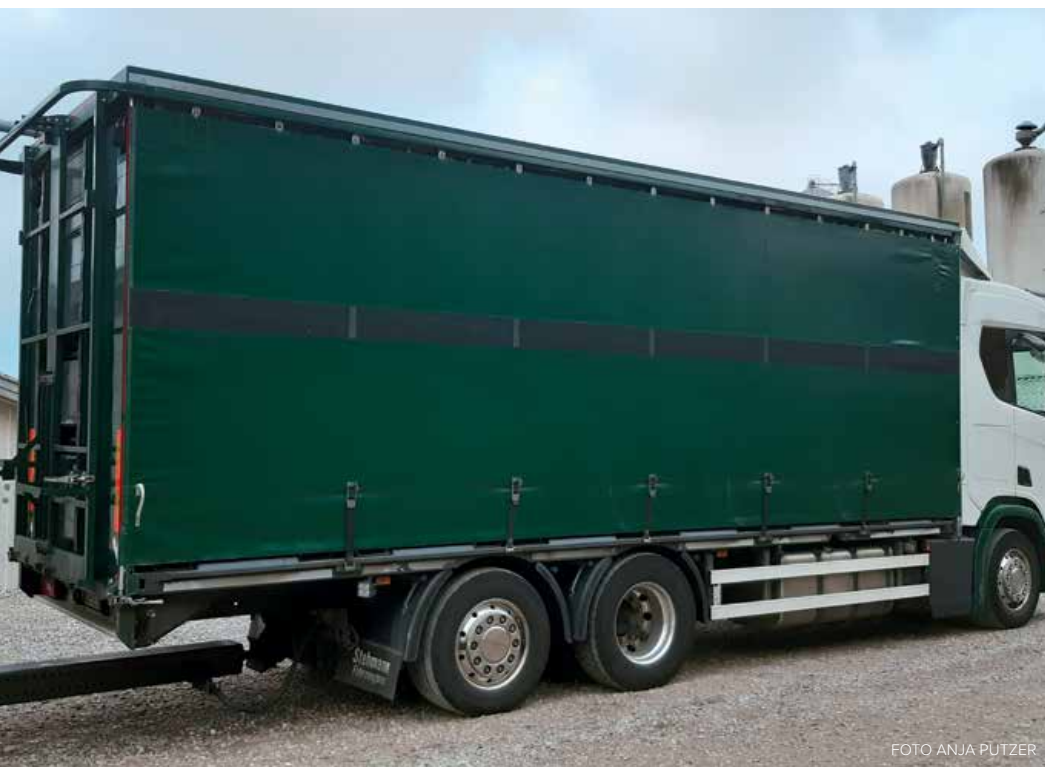
Figur 3. Lastbil til kyllingetransport. Lastbilen har lukket tag og åbne sider, som kan lukkes med presninger afhængigt af vejret. Dette foto viser en lastbil, som anvendes til eksport af levende kyllinger, men principperne er de samme.
